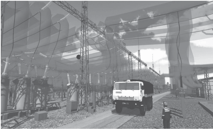
Рис. 2. Визуализация зон электробезопасности. Опасные зоны смоделированы и визуализированы как полупрозрачные трубки вокруг проводников (токоведущих проводов). Опасные зоны для рабочих окрашены в красный цвет, для техники — в синий (не показаны на рисунке). Интерактивная 3D-модель подстанции 220 кВ «Абакан-Районная» (Михаил Аникушкин, Александр Бобков, Андрей Леонов и др.).
